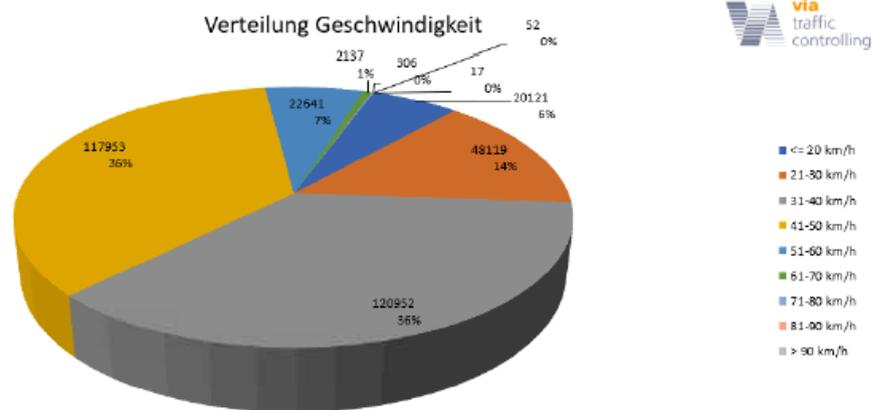
Die max. gefahrene, erfasste Geschwindigkeit war 112 km/h. Lt. dem Gerät sind 17 Fahrzeuge mehr als 90 km/h gefahren.
